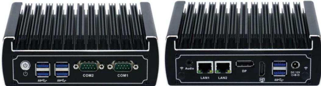
PC industriale di colore nero interamente realizzato in alluminio di spessore generoso per garantire una robustezza e una dissipazione adatta per ogni tipo di ambiente. Il sistema è totalmente Fanless. Offre una grande resistenza a polveri ed agenti esterni. L'elettronica di questo modello è interamente allo stato solido.
